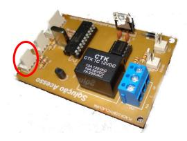
Este conector permite com que um leitor de dados com saída no formato Wiegand26 seja utilizado na placa. A pinagem para acesso a este conector está descrita abaixo:
