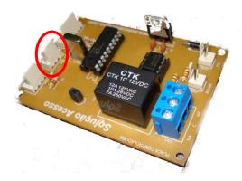
Este conector permite com que um leitor de dados com saída no formato Wiegand26 seja utilizado na placa.
