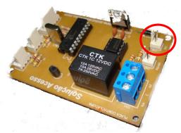
A placa é alimentada com 12V com uma corrente mínima de 500 mA. O pino mais próximo do diodo é a entrada 12 V e o outro pino é o GND.
