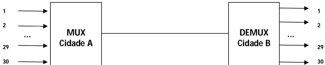
O que temos acima é um exemplo de multiplexador, ele envia seqüencialmente os canais que neste caso são de 1 a 30 e o DEMUX (demultiplexador) da cidade B seqüencialmente conecta a saída o canal que está sendo multiplexado no momento. Poderíamos montar um circuito multiplexador com base em chaves e teríamos algo como o apresentado a seguir, de forma a facilitar a compreensão de multiplexadores:
