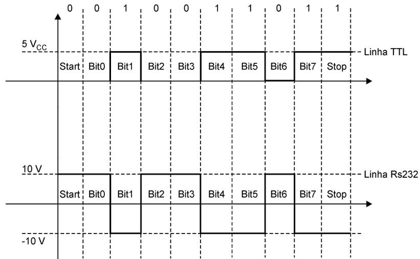
Verifique que o bit de start sempre começa em 0 seguido dos bits de dados e finalizado pelo bit de stop que sempre finaliza em 1, e a linha de dados volta a seu estado de repouso.
