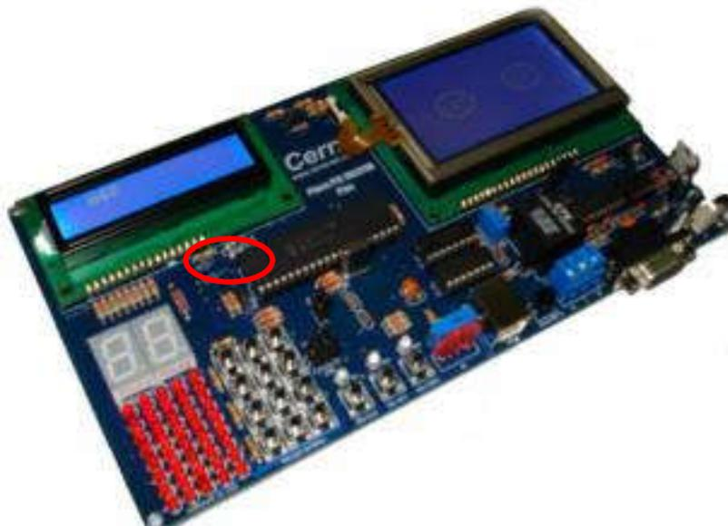
**Obs.:** A placa não será reconhecida pelo sistema de gravação se estes jumpers estiverem abertos ou posicionados para a direção LCD. Apenas as placas com suporte ao gravador Cerne USB apresentam este jumper, ficando o restante sem este jumper de configuração.
