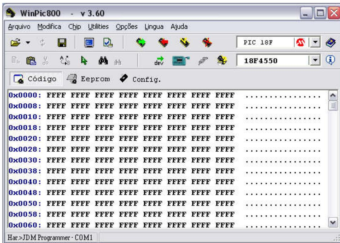
**Passo 4.** Agora vamos configurar o gravador utilizado pelo WinPIC800. Para isso, vá no menu Opções -> Hardware. Na Janela que for aberta, escolha o gravador JDM Programmer. Após este passo, deixe a configuração deste gravador como a apresentada abaixo:
