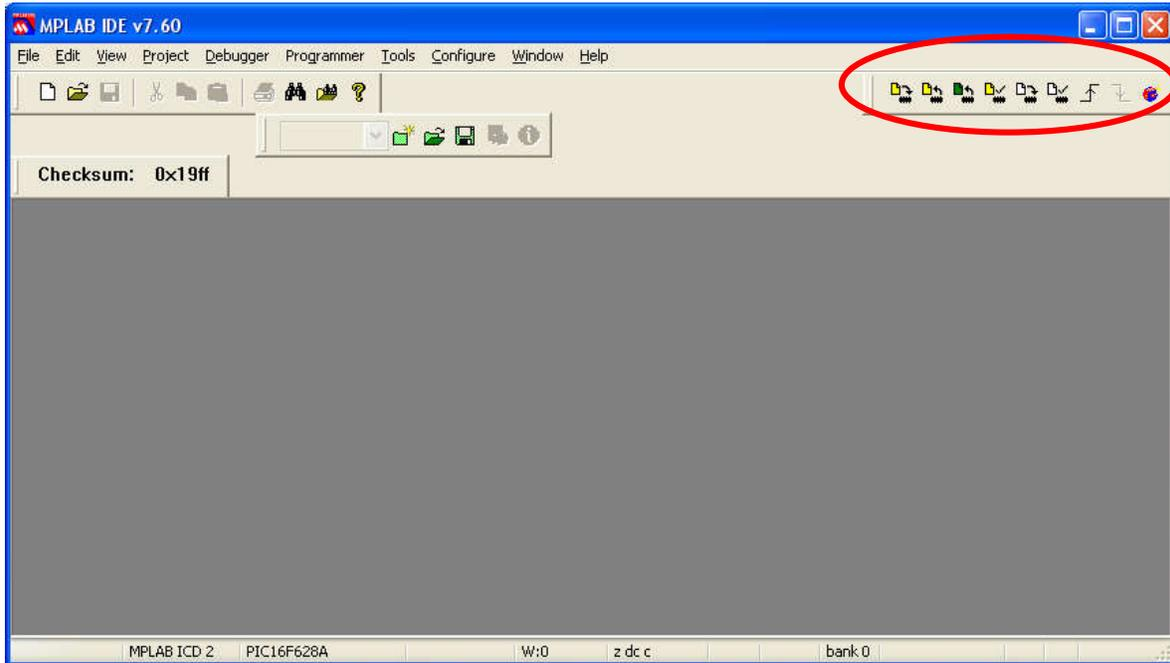
Antes de prosseguirmos, será necessário alterar um pequeno detalhe de configuração. Sempre que o microcontrolador for gravado diretamente na placa, o mesmo deverá ser alimentado pelo próprio gravador e quando alguma gravação do tipo in-circuit (ICSP) for feita, a alimentação será proveniente do circuito que alimenta o PIC. Para ajustarmos este parâmetro, vá no menu Programmer -> Settings. A seguinte tela surgirá:
