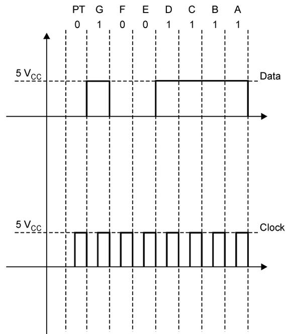
Para que o exemplo funcione, é preciso construir uma rotina de comunicação com o shift-register para que possamos carregar o mesmo. O shift-register que estamos utilizando é o 74HC164. Ele tem duas linha de comunicação, uma chamada DATA (de dados) e outra clock.
